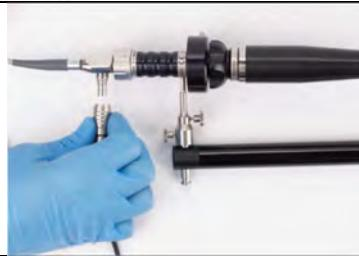
14. Fixe os cabos ao longo do braço. Certifique-se de não apertar os cabos (luz e câmera) para dar liberdade de movimento ao braço e não danificar os cabos.
